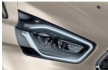
Bi-Xenon-Scheinwerfer mit statischem Kurvenlicht, LED-Tagfahrlicht und Nebelscheinwerfern
